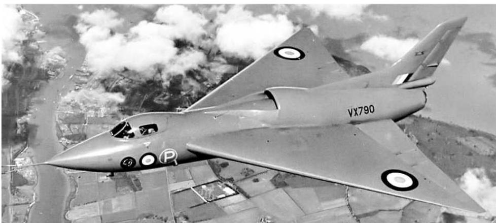
Flugtests der 707B aus Dunsfold rechtfertigten bald Avros Glauben an den Deltaflügel und seine relativ sanften Flugeigenschaften. Im Februar 1951 wurde die Gabelung des oberen Lufteinlasses durch eine effizientere und elegantere Einzelsaugung mit einem NACA Venturi-Einlass ersetzt, und im August 1951
