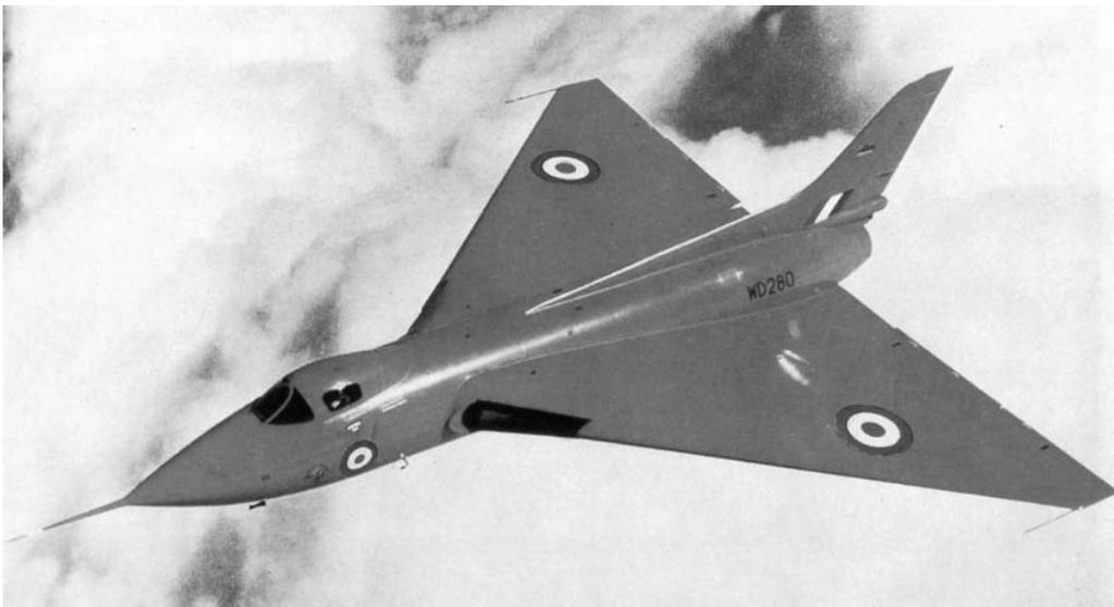
Das dritte Flugzeug der Baureihe war der Typ 707A (serienmäßig WD280), der am 14. Juni 1951 zunächst in Boscombe Down flog, nachdem er wie sein Vorgänger von Woodford abtransportiert worden war. Dieses Flugzeug wurde entworfen, um bei hohen Unterschall-Machzahlen zu fliegen und unterschied sich von dem 707B darin, einen verkleinerten Typ 698
