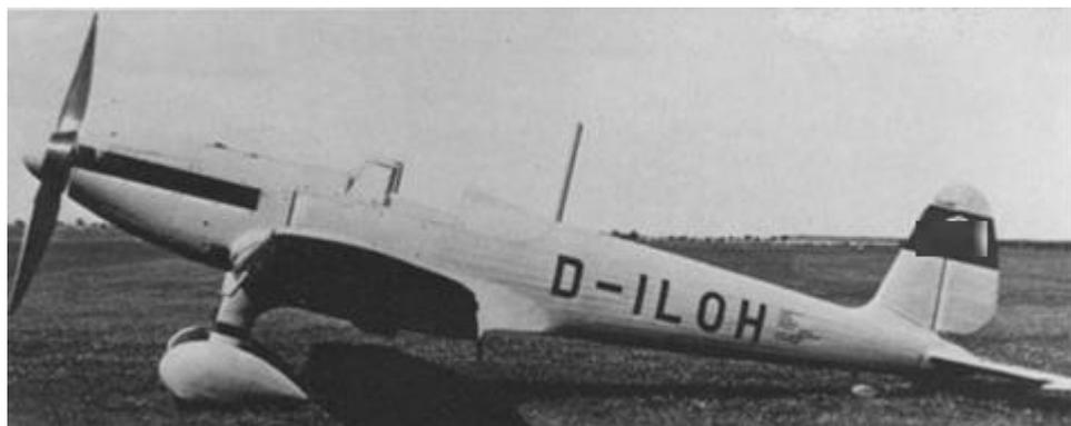
Das Flugzeug sollte mit dem Junkers-Jumo-210-Motor und einem nicht verstellbaren hölzernen Zweiblattpropeller ausgerüstet werden. Da dieses Triebwerk bis zum Vergleichsfliegen jedoch noch nicht fertig wurde, musste ein Ersatztriebwerk beschafft werden. Zufälligerweise hatte Arado bereits einen Rolls-
