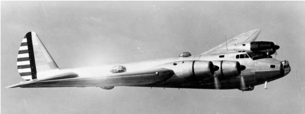
Mit den eingebauten Twin Wasp Sternmotoren - die gleiche Anzahl und Art von Motoren wie bei der späteren Consolidated B-24 Liberator mit einzelnen Turboladern, die den Twin Wasp-Triebwerken der Liberator hinzugefügt wurden - die spezifizierte Geschwindigkeit von 320
