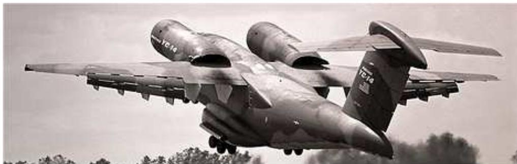
Direkt hinter den Triebwerken befanden sich große Doppelspaltklappen, die bis zu 70 Grad ausgefahren werden konnten. Durch den Coandă-Effekt blieb der Triebwerksstrom dabei an der Klappenoberfläche „haften“, wodurch sehr
