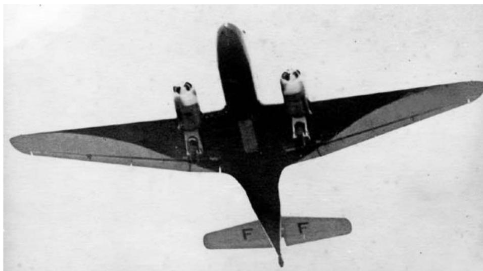
Die Breguet 670 wurde so konzipiert, dass sie für die Beförderung von Gütern oder Post anstelle von Passagieren angepasst werden konnte. Mit einer Nutzlast von 2.030 kg betrug die Reichweite 750 km, aber durch die Reduzierung auf 1.320 kg wurde die Reichweite auf 1.500 km erhöht.
