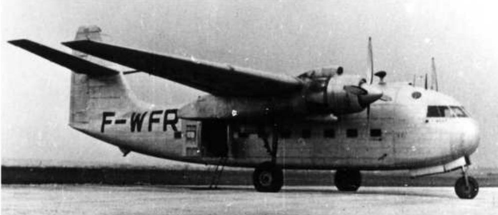
Zweimotoriger Frachter / kommerzieller Transport-Prototyp, angetrieben von zwei 2.000 PS (1.491 kW) Bristol Hercules- Sternmotoren, einer gebaut, zuerst im April 1950 geflogen. Später wurde die 892S-Variante auf den 890H-Standard modifiziert.
