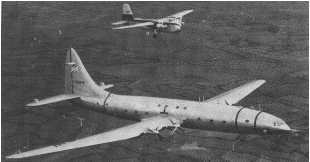
Leistung über Fernwellen angetrieben wurden. Die insgesamt 8 Motoren waren nicht in üblichen Motorgondeln, sondern innerhalb der Tragflächen versenkt untergebracht. Die Schwierigkeiten mit den schräg zueinander eingebauten Triebwerkspaaren, die jeweils über ein gemeinsames Getriebe gekoppelt waren, konnten letztlich nie ganz behoben werden. Diese Technologie war bei praktisch allen derartigen Versuchen (siehe Heinkel He 177 oder Saunders-Roe Saro Princess) nicht in den Griff zu bekommen.
