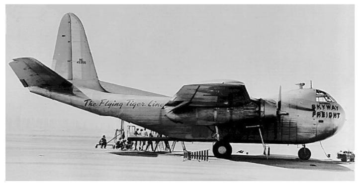
beide Fahrwerke simultan einzufahren. Durch die Verwendung des rostfreien Stahls war das Flugzeug deutlich schwerer, so war die Leermasse der C-93 um 1.362 kg höher als die der C-47. Da beide Modelle dieselben Triebwerke verwendeten, schien die C-93 deutlich untermotorisiert. Auch der Kraftstoffverbrauch war wesentlich größer als erwartet, so dass die Reichweite deutlich absank.
