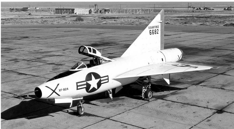
Von Beginn an dachten die Konstrukteure auch daran die XF-92A im Überschallflug einzusetzen. Nach den damaligen Berechnungen sollte sie in der Lage sein im Horizontalflug Mach 1 zu überschreiten. Die Piloten jedoch beurteilten die Maschine als nicht überschallfähig, so dass sie nach Ende der „Phase II“ im Januar 1950 ins Werk zum Tausch des Triebwerks gegen eine mit Nachbrenner versehene 33,4 kN Schub
