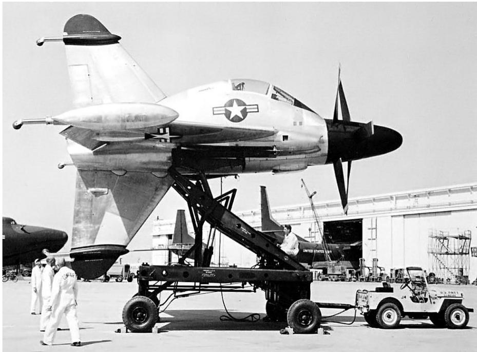
vordere Seil konnte durch eine Seilwinde, welche von einem Testingenieur bedient wurde, gespannt werden, um im Notfall das Flugzeug in eine stabile, vertikale Position zu bringen. Nicht vorgesehen war der Umstand, dass der Luftstrom der XFY-1 an den Hangarwänden zurückgeworfen wurde und starke Turbulenzen erzeugte, weshalb die Tests mehrmals abgebrochen wurden. Dennoch absolvierten die Tester über 60 Flugstunden in dem Hangar.
