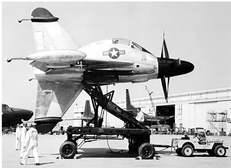
erste Mal ab, von vier Seilen an den Leitwerksspitzen und einem an der „Nase“ gesichert. Das vordere Seil konnte durch eine Seilwinde, welche von einem Testingenieur bedient wurde, gespannt werden, um im Notfall das Flugzeug in eine stabile, vertikale Position zu bringen. Nicht vorgesehen war der Umstand, dass der Luftstrom der XFY-1 an den Hangarwänden zurückgeworfen wurde und starke Turbulenzen erzeugte, weshalb die Tests mehrmals
