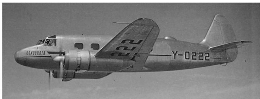
Als Antrieb verwendete man zwei luftgekühlte Alvis Leonides L.E.4M Neunzylinder-Sternmotoren mit einstufigem Radiallader und Kraftstoffeinspritzung, die als die modernsten und sparsamsten Motoren ihrer Klasse galten. Über ein Untersetzungsgetriebe wurden die beiden Hamilton Standard Dreiblatt-Metallpropeller angetrieben.
