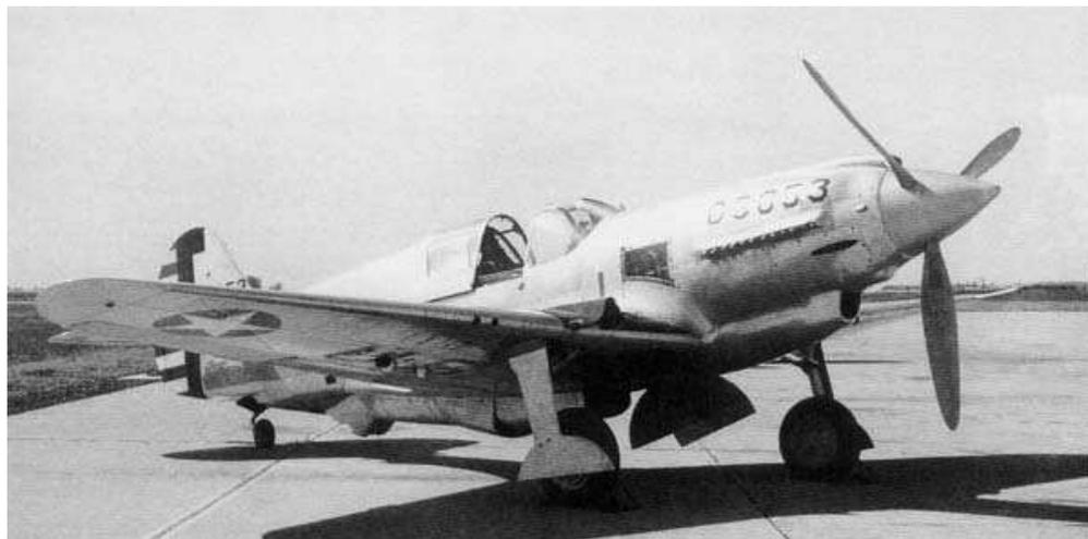
Zwei Prototypen mit der Bezeichnung **XP-46A** wurden dennoch an die USAAC geliefert; der erste Flug erfolgte am 15. Februar 1941. Die Leistung des Typs während der Versuche war niedriger als die der damaligen P-40D. Da der P-46 keine wesentliche Verbesserung gegenüber dem P-40 bot, wurde das Programm abgebrochen.
