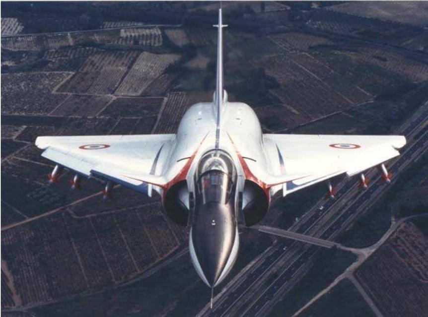
Die Mirage 4000 hatte eine Länge von 18,7 Metern, eine Spannweite von 12 Metern und eine Höhe von 5,8 Metern. Sein Leergewicht lag bei 13.400 kg. Im Vergleich dazu hatte die Mirage 2000 eine Gesamtlänge von 14,3 Metern, eine Spannweite von 9 Metern und eine Höhe von 5,2 Metern.
