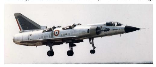
Im Juni 1966 startete der zweite Prototyp mit einem TF306-Turbofan-Triebwerk für den Vorwärtsschub von 82,4 kN seinen ersten Flug. Im September desselben Jahres erreichte er Mach 2.04 im Horizontalflug, ging aber am 28. November 1966 bei einem Unfall verloren. Die Mirage IIIV war niemals
