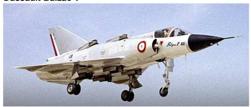
Da erwartet wurde, dass die Rolls-Royce RB162 Hubmotoren, die für die Mirage IIIV spezifiziert wurden, nicht vor 1963 verfügbar waren. beschloss Dassault, den ersten Mirage III Prototyp zu vorläufigen Testmaschine modifizu zieren; in dieser Konfiguration wurde es der Balzac V. Diese wurde mit acht
