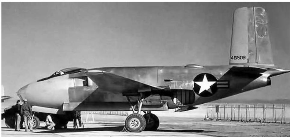
Die XB-43, die in einem folgenschweren technologischen Wandel begriffen war, trug dazu bei, Verfahren zum Fliegen der neuen Düsenbomber zu entwickeln, und sie prüfte neue Turbostrahltriebwerke. Douglas fertigte den zweiten Prototyp mit der AAF-Seriennummer 44-61509 am 15. Mai 1947 ab und lieferte ihn im April 1948 an die Muroc Air Force Base in Kalifornien.
