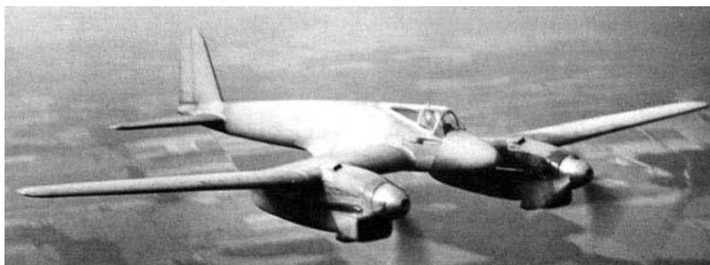
Blaser passte das Design an, indem er den Rumpf leicht streckte, aber die Einbeziehung eines zweiten Besatzungsmitglieds änderte den Schwerpunkt, der verlangte, dass die Triebwerks gondeln modifiziert wurden, um Änderungen der Flugeigenschaften zu
