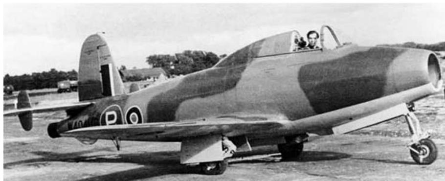
Die E.28/39 war ein Tiefdecker, speziell entwickelt, um das neu entwickelte Düsentriebwerk zu erproben. Es wurde beschrieben, dass es aufgrund eines runden Rumpfes ein leicht fassartiges Aussehen besitzt. Durch den Wegfall konventioneller Propeller auf den Boden konnte die E.28/39 mit einem ungewöhnlich kurzen Fahrgestell für damalige Zeit
