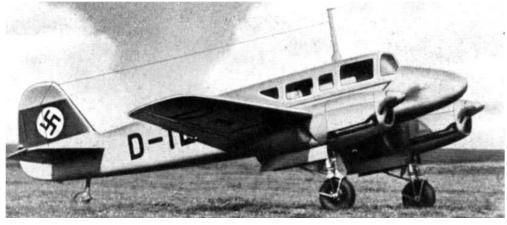
Am 14. Dezember 1936 startete mit der zivilen Kennung D-IFSL der Prototyp Go 146 V1 zu seinem Jungfernflug. Der zweite Prototyp mit der Kennung D-ILPC startete Anfang 1937 zu seinem Erstflug. Beide Maschinen hatten luftgekühlte hängende Achtzylinder Reihenmo-
