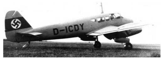
Als Triebwerke sah man jetzt zwei Hirth HM 508E, ebenfalls luftgekühlte hängende Achtzylinder Reihenmotoren, vor. Der dritte Prototyp Go 146 V3, der gleichzeitig das erste Nullserienmuster war, startete am 28. August
