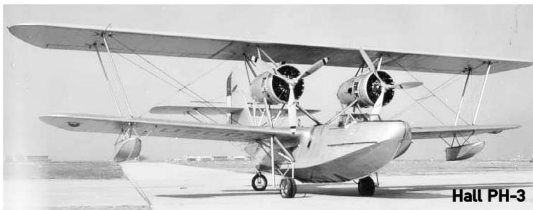
oberen Tragflächen zu haben. Die beiden Tragflächen waren durch zwei kräftige I-Stiele miteinander verbunden und zusätzlich mit Drahtseilen kreuzweise verspannt. Für eine platzsparende Unterbringung konnten die Außenflügel um 90 Grad nach hinten geschwenkt werden.
