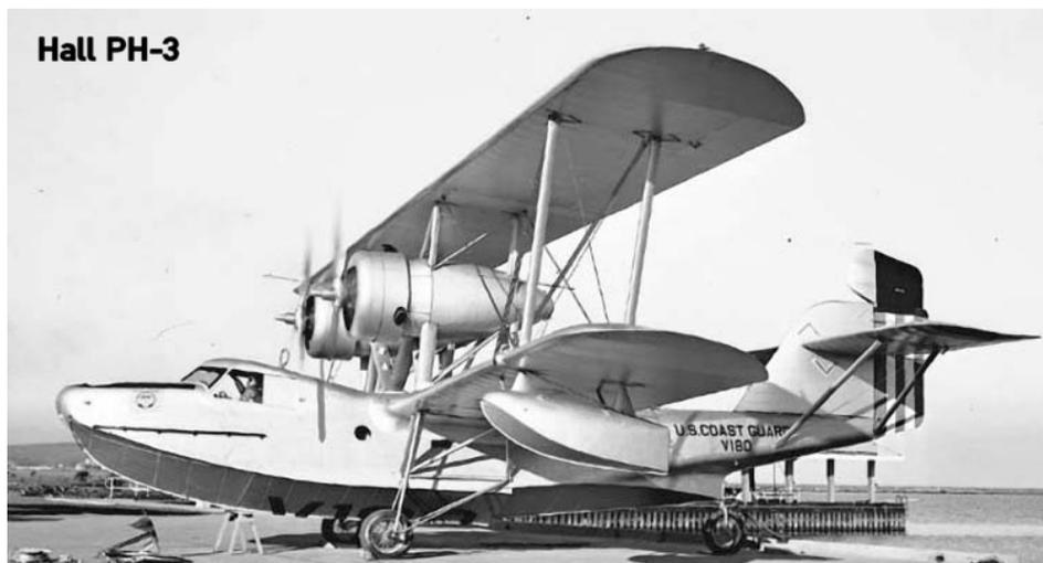
Die Hall XPH-1 war ein zweimotoriges Doppeldecker-Flugboot mit zweifach abgestuften Bootsumpf, einem offenen Cockpit, Normalleitwerk und mit je einem ungestuften Stützwimmer unter den unteren Tragflächen in Gemischtbauweise. Als Motoren wurden die luftgekühlten Neun-Zylinder-Sternmotoren Wright R-1750 Cyclone 9 mit einer Startleistung von je 537 PS von der US Navy vorgeschrieben. Die Motoren waren auf Stützböcken zwischen den Tragflächen montiert.
