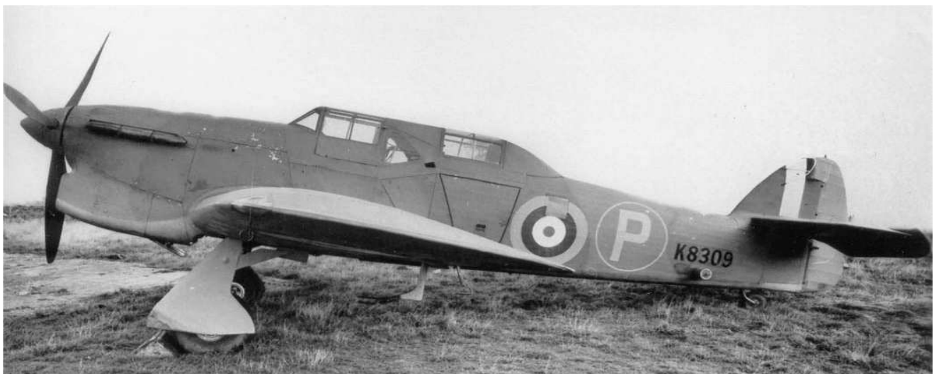
Hotspur nach Umbau der Kanzel
