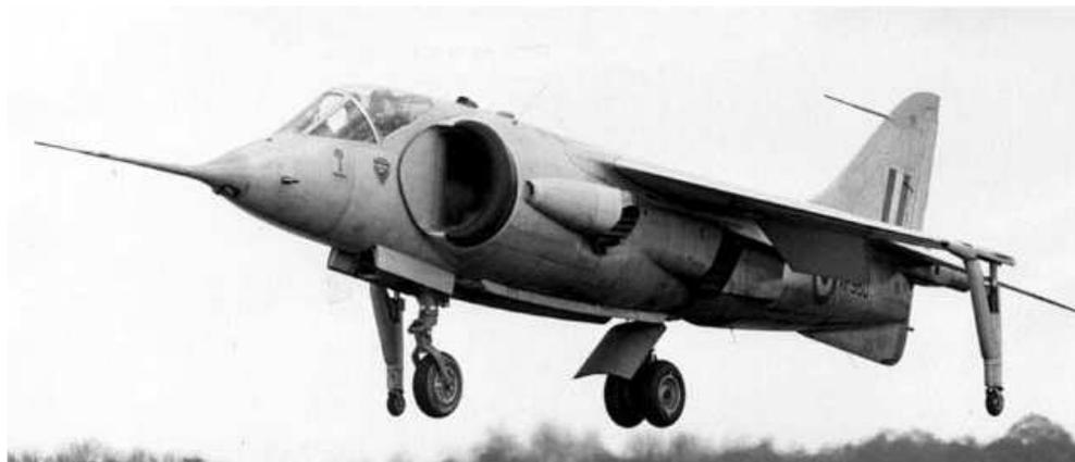
Der Testpilot Bill Bedford begann das Entwicklungsprogramm mit vier Rollversuchen auf dem Dunsfold Aerodrome. Vor dem ersten Flug wurde sämtliche entbehrliche Ausrüstung mit einem Gesamtgewicht von 320 kg ausgebaut um Gewicht zu sparen. Nur 17 Monate nach dem Beginn des Zellenbaus führte
