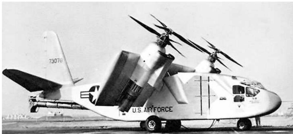
Der Schub von diesem Hilfsmotor wurde durch ein Rohr abgeleitet, das aus dem hinteren Teil des Flugzeugs herausragt und mit einem Auf-und-Ab-Ventil abgeschlossen wurde. Durch Anwenden des Schubs in einer Aufwärts- oder Abwärtsrichtung war das Gerät in der Lage, die Tonhöhensteuerung des Fahrzeugs beizubehalten.
