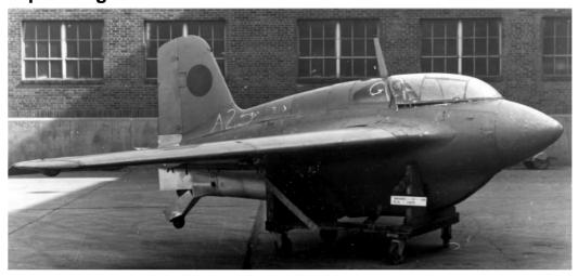
Da die Triebwerke noch nicht fertiggestellt waren, wurden am 8. Januar 1945 erste Gleitflugversuche vorgenommen. Mit dem ersatzweise eingebauten Ballast waren die Flugleistungen denen einer gleitenden Me 163 sehr ähnlich. Das erste der "Toku Ro.2" (KR10) genannten Raketentriebwerke wurde im Juni geliefert, als der Krieg in
