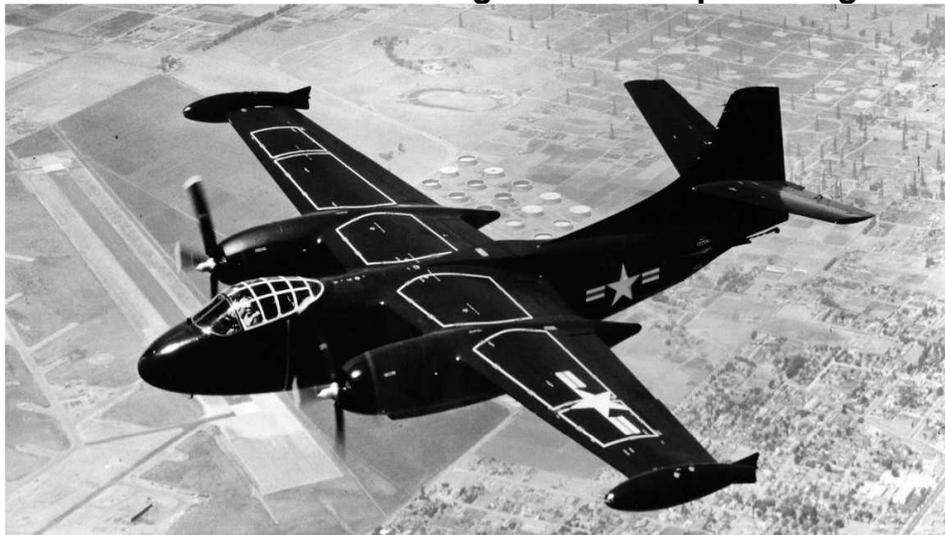
Die **North American AJ Savage** war ein strategischer Bomber der U.S. Navy, der von 1949 bis Anfang der 1960er Jahre eingesetzt wurde. Sie war mit Kolbenmotoren und einem Strahltriebwerk ausgerüstet.
