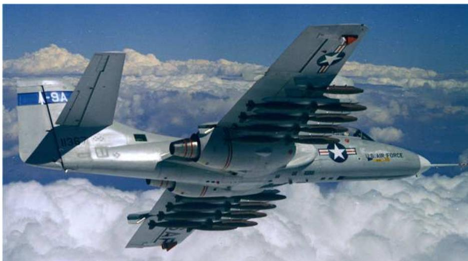
Der Pilot saß unter einem großen Kanzeldach deutlich vor der Vorderkante der Flügel. Das Cockpit war von einer Wanne aus Panzerung umgeben (Aluminium in den Prototypen, das bei der Produktion durch Titan ersetzt worden wäre), während die am Flügel montierten Treibstofftanks selbstdichtend und mit Schaum gefüllt waren, um Brände oder massiven Treibstoffverlust zu minimieren. Zwei redundante hydraulische Flugsteuerungssysteme wurden mit
