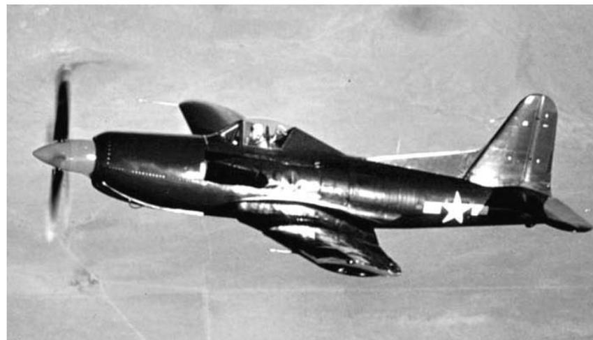
Die Ryan XF2R Darkshark war ein experimentelles Flugzeug, das für die US Navy gebaut wurde, in dem Turboprop- und Turbostrahltrieb kombiniert wurden. Es basierte auf den früheren Ryan FR Fireball, der Kolbenmotor des Fireballs wurde durch ein Turboprop-Triebwerk von General Electric T-31 ersetzt mit einem Vierblatt-Standardpropeller von Hamilton.
