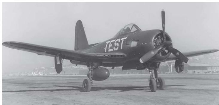
Die **Ryan FR Fireball** war ein US-amerikanisches Jagdflugzeug mit kombiniertem Kolbenmotor- und Strahlantrieb, das gegen Ende des Zweiten Weltkrieges entworfen wurde. Die **FR-1** war das erste Flugzeug der US Navy mit Strahlantrieb, kam aber im Krieg nicht mehr zum Kampfeinsatz.
