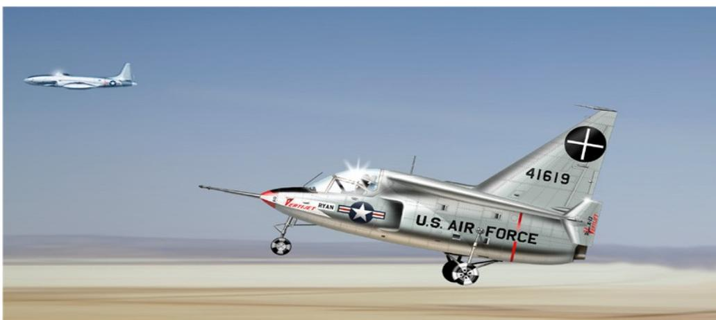
Am 28. Mai 1956 fand der erste vertikale Schwebeflug statt. Die Techniker hatten am zweiten Prototyp das Fahrwerk weggelassen, anstelle des Bugrads war ein Fanghaken angebracht, und die Haupträder waren zu kleinen Stützen reduziert worden. Die X-13 sollte sich mit dem Haken an einem Seil einklinken, welches an einer Startrampe befestigt war. Da der Pilot eine schlechte Sicht
