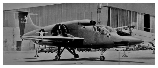
Den Einsatz von Strahltriebwerken als Hubtriebwerke schränken ein hoher Kerosinverbrauch und große Geräuschentwicklung stark ein. GE plante ein System, dass statt des schnellen, heißen Abgasstrahls eines Strahltriebwerks, einen vielfach größeren aber langsameren und kalten Massenstrom zum Vertikalstart und
