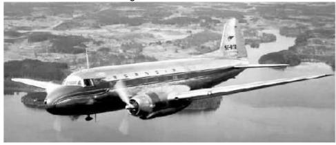
Der Rumpfdurchmesser wurde gewählt, um vier Sitze pro Reihe zu ermöglichen. Diese Konfiguration ergab eine Kapazität von 32 Passagieren. Eine Konfiguration mit breiteren und bequemeren Sitzen, drei Sitzen pro Reihe, die insgesamt 24 Passagiere befördern, wurde ebenfalls angeboten. Der Prototyp (90.001) wurde mit 1.400 PS Pratt & Whitney
