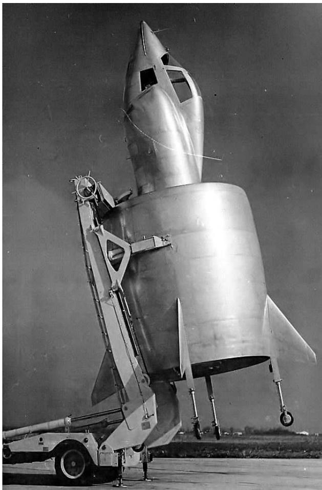
Die **SNECMA C.450 Coléoptère** war ein VTOL-Experimentalflugzeug, in welchem zwei unkonventionelle Konzepte vereint wurden: Es handelte sich um einen Heckstarter mit Ringflügel. Wie bei der US-amerikanischen Ryan X-13 nutzte man ein Strahltriebwerk, jedoch kam die Coléoptère ohne Startrampe aus. Stattdessen waren an der hinteren Kante des Ringflügels feste Rollen angebracht, auf denen das Flugzeug senkrecht ruhte.
