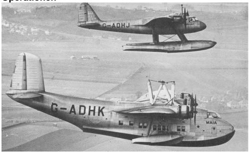
Die erste erfolgreiche Trennung während des Fluges wurde am 6. Februar 1938 in den Short-Werken in Borstal bei Rochester. Medway, und bei Maia von Parker und *Mercury* von Harold Piper durchgeführt. Nach weiteren erfolgreichen Tests wurde der Transatlantikflug am 21. Juli 1938 von Foynes an der Shannon-Mündung an der Westküste Irlands nach Boucherville bei Montreal, , einer Kanada, mit Flugstrecke von 4.714,4
