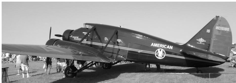
Hinter dem mit einer NACA Haube widerstandsarm verkleideten Bugmotor befand sich ein Tank mit 379 Litern Kraftstoff. Der zweiholmige Tragflügel bestand aus einem Tragflächenmittelstück und je einem Außenflügel mit trapezförmigem Grundriss. Die Holme und Querverbinder waren aus hochfesten
