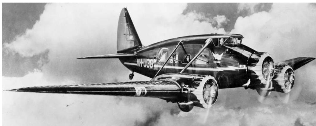
Das elektrisch einziehbare Hauptfahrwerk fuhr nach vorn in die Motorgondeln ein, wobei im eingefahrenen Zustand die Haupträder noch zur Hälfte aus den Gondeln ragten, um bei Notlandungen mit eingefahrenem Fahrwerk den Tragflügel zu schützen.
