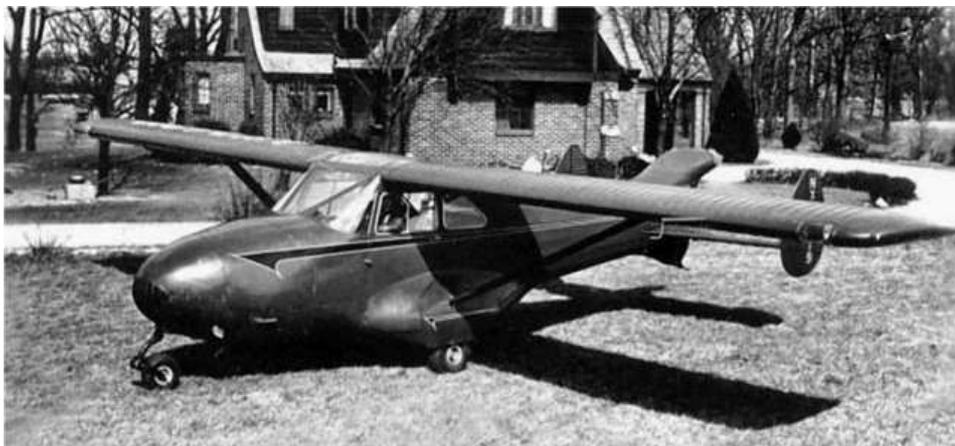
Zum Schutz der Luftschraube war das Rumpffende flossen-förmig nach unten gezogen und verfügte außerdem noch zusätzlich über eine Schleifkufe aus Stahl. Im ausgefahrenen Zustand konnten die Haupträder vom Motor über einen zuschaltbaren Antriebsstrang auf eine Rollgeschwindigkeit von 24 km/h beschleunigt werden und so konnte sich das Flugzeug am Boden mit eigener Kraft und stehender Luftschraube bewe-
