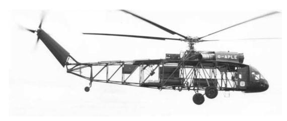
Zunächst waren zwei Varianten vorgesehen: ein zivilen Nahverkehr mit 40 Sitzen und ein fliegender Kran mit einer Tragfähigkeit von 7500 kg. Im 1956 ent-März schied sich Westland, den ersten Prototyp als fliegenden Prüfstand mit
