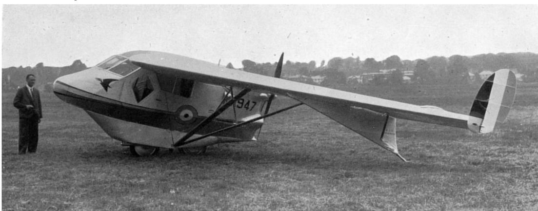
Dreisitziger Kabinen Eindecker von 13,51 m Spannweite und 5,94 m Länge, produziert im Jahr 1931. mit Pitch-and-Roll-Steuerung von Elevons. Auch ein abgestützter Eindecker, die Flügel hatten variable über einen kleinen Be-
