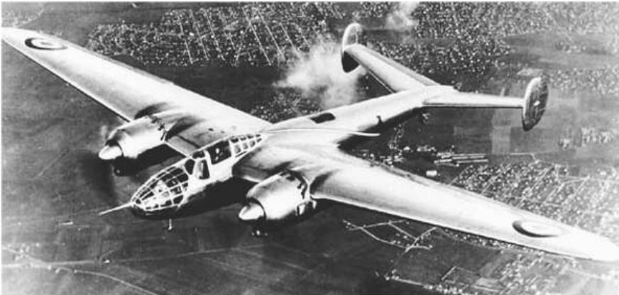
1934 wurde der ursprünglich als Postflugzeug vorgesehene Typ Amiot 340 konzipiert. Es handelte sich um einen zweimotorigen Mitteldecker in Ganzmetallbauweise. Schon bald erkannte man das Potential, die Konstruktion zu einem mittleren Bomber weiterzuentwickeln, und so wurde der Prototyp entsprechend modifiziert. Seinen Erstflug hatte er im März 1938, nunmehr unter der Bezeichnung *Amiot 350*. Auf Grund
