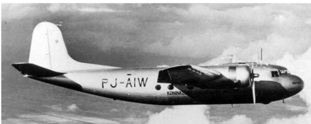
Als Triebwerke fanden beim Prototyp zwei luftgekühlte 9 Zylinder Sternmotoren Wright Cyclone SGR-1820-F-62 Verwendung. Hinter den Triebwerken befanden sich die Öltanks mit je 120 Litern Fassungsvermögen. Die Serienmaschinen erhielten Wright Cyclone SGR-1820-G102A mit 1.100 PS
