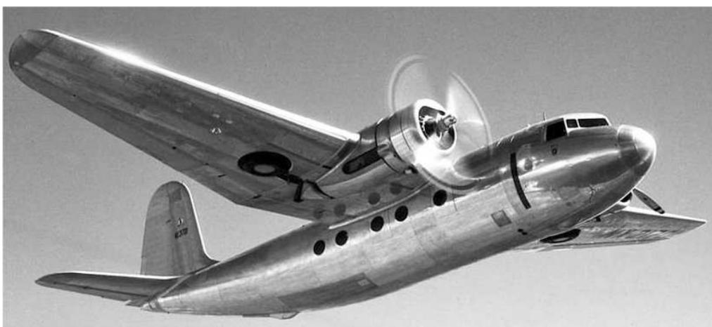
Die Tragfläche war dreiteilig aufgebaut. An ein durch die Kabine führen-des gerades Tragflächenmittelstück, das nach Douglas-Bauweise dreiholmig aufgebaut und mit verschiedenen dicken Leichtmetallblechen selbsttragend verkleidet war, befanden sich an den Enden die Triebwerksträger und das Hauptfahrwerk, das zu den Außenflügeln hin
