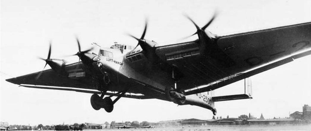
Bereits am 3. Oktober 1931 kam die Maschine wieder in die Junkers-Werft. Sie erhielt dort ein Zwischendeck für größere Frachtkapazität. Die Passagieranzahl konnte von 19 auf 30 erhöht werden. Ein Tausch der zwei L8a-Motoren gegen solche vom Typ L88a verbesserte nochmals
